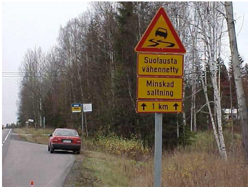
Figure 7. Signalisation du risque de verglas (réduction de l'épandage de sel sur un 1 km)
