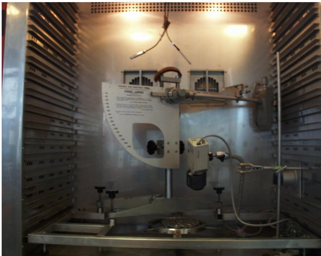
Figure 2: Appareil de mesure des indices de friction.
