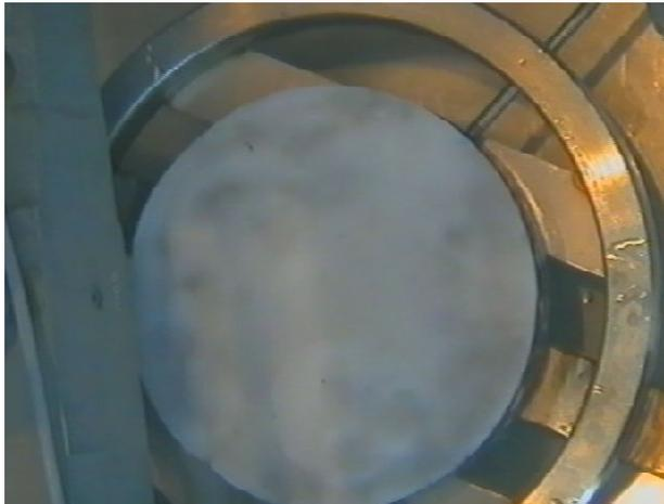
**Figure 4: Couche extérieure continue d'hydrohalite sur un revêtement, SMA+Hydrohalite (g)**
