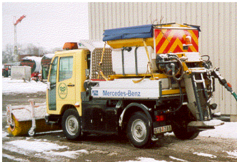
Fig. 1. Le camion Mercedes Benz UX 100 utilisé pour l'étude grandeur nature, équipé de la brosse montée à l'avant pour le déneigement et l'épandeuse centrifuge pour l'eau saumâtre, ou sel pré-humidifié.
