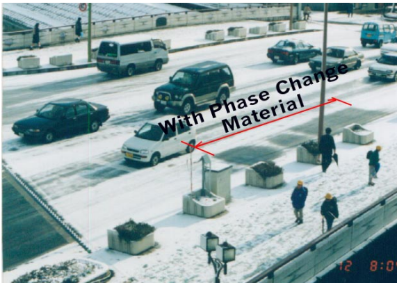
Fig. 25 Fonte de la neige sur un platelage métallique avec et sans matériau à changement de phase
