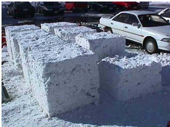
Préparation des blocs de neiges à mettre dans le bac
