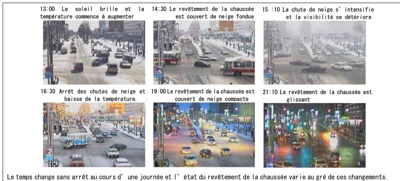
**Figure 7 Image des conditions météorologique et du revêtement de la chaussée**
