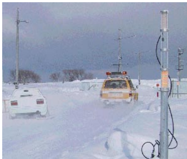
Figure 6 Expérience de conduite : à gauche se trouve un panneau simulant l'obstacle; à droite le délinéateur lumineux expérimental.
