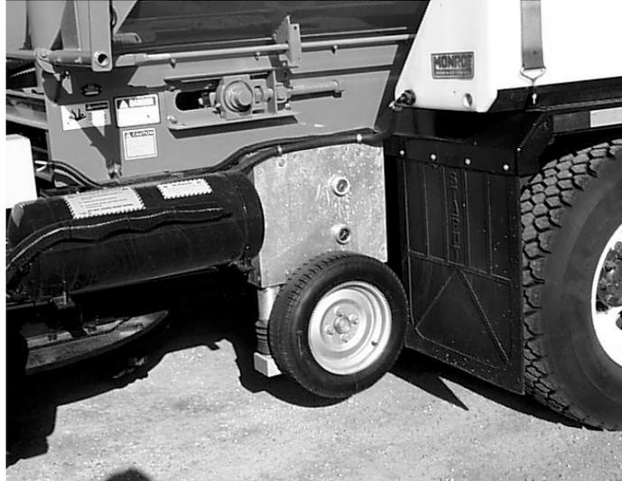
**Figure 4: Le SALTAR, Appareil de Mesure de Frottement Monté sur une Saleuse/Déneigeuse**
