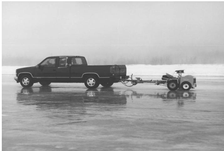
**Figure 1. La Remorque du ROAR Utilisée pour la Mesure de Frottement**
