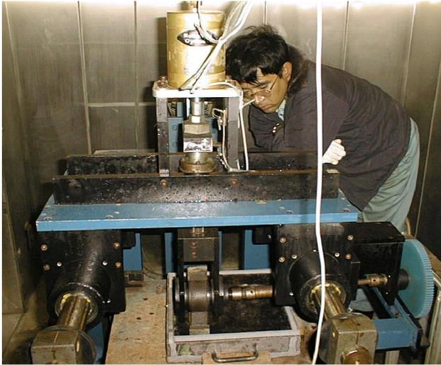
Photo 5 Vue de l'essai de rupture du glace-panneau
