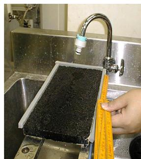
Photo 2 Vue d'essai de cisaillement de glace-panneau
