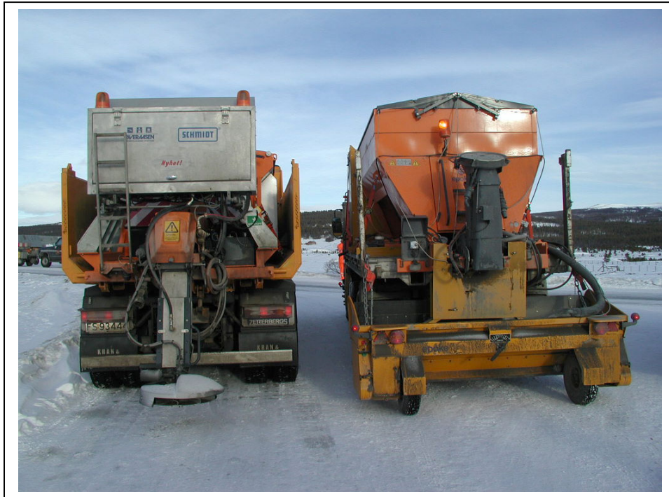
FIGURE 5 Nouveau Concept du Sable Humidifié Chaud. Le Camion à gauche peut aussi être utilisé pour l'épandage du Sel.
