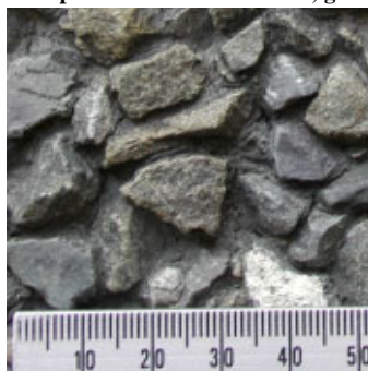
Exemple 3: Chaussée Utilisée, gravier de 16mm de type "Grade 3", Profondeur Moyenne=1.08mm
