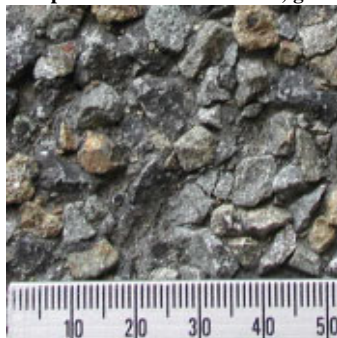
Exemple 4: Chaussée Intacte, gravier de 9mm de type "Grade 5", Profondeur Moyenne=1.88mm
