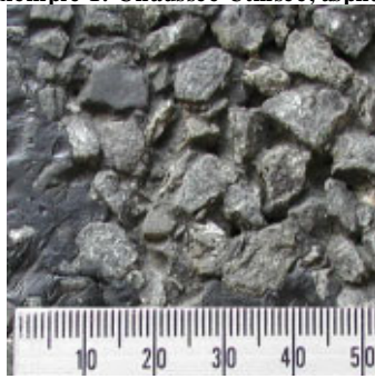
Exemple 2: Chaussée Intacte, gravier de 16mm de type "Grade 3", Profondeur Moyenne=2.15mm
