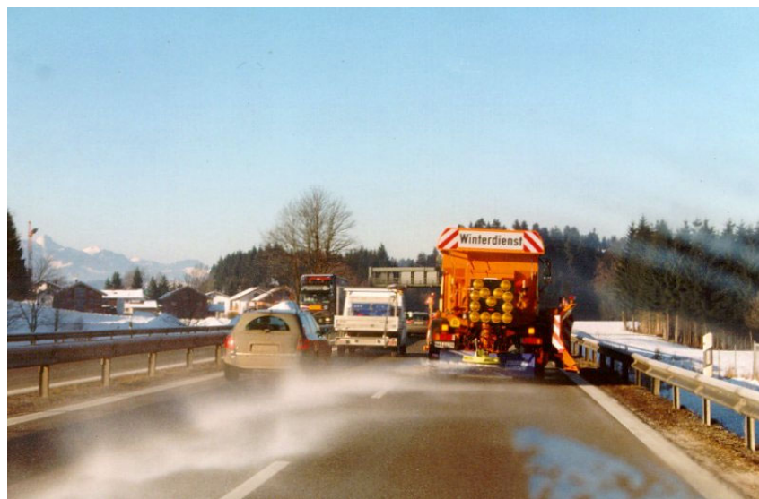
Illustration 5: Epandage de sel sec (Sel salin à grains fins, environ 30 g/m 2 à environ 50 km/h)
