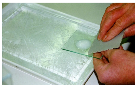
Illustration 3: Application du sel pré-humidifié sur la plaque de glace
