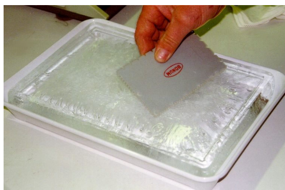
Illustration 4: Répartition du sel préhumidifié sur la plaque de glace à l'aide d'une spatule dentée
