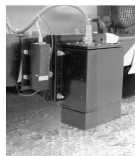
Photo 14 : Mesure de coefficient de frottement
