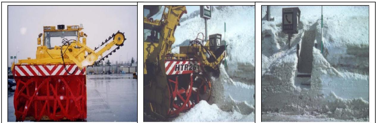
Fig. 9 Elimination de la neige autour d'un téléphone d'urgence avec une déneigeuse
