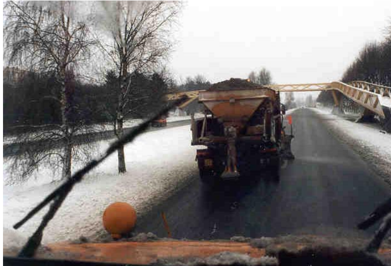
fig. 3 : raclage et retraitement sur une voirie périurbaine
