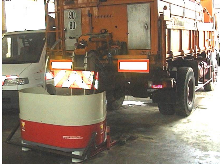
fig. 8 :Mesure du dosage avec l'appareil DORSA
