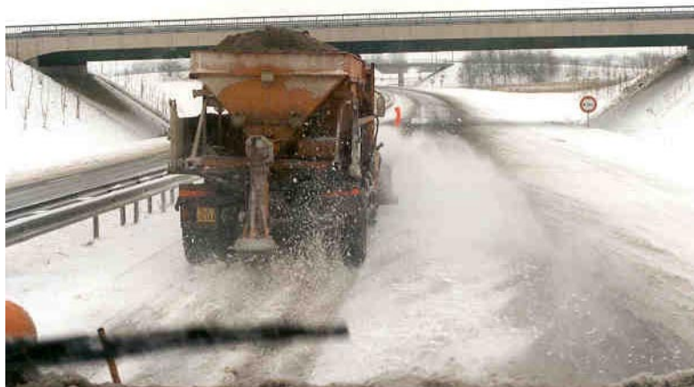
fig. 4 :Epannage de fondant sur neige humide en cours de fusion
