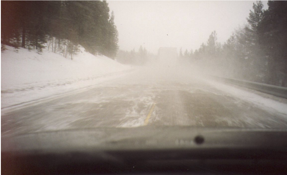
Figure 2. Réduction de la visibilité derrière les camions à cause de « fumée neigeuse ». Notez la silhouette du camion et la visibilité réduite sur la gauche. (Crédit photographique : Dagfinn Moe, SINTEF, Trondheim)
