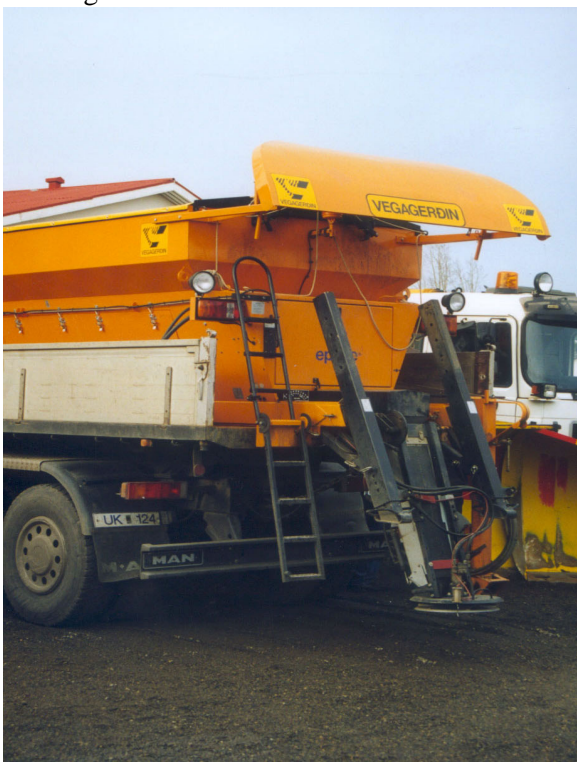
Figure 6. Camion d'entretien des routes équipé d'un becquet pour éviter le dépôt de neige sur le disque de salage. (Photographie Thordarson)
