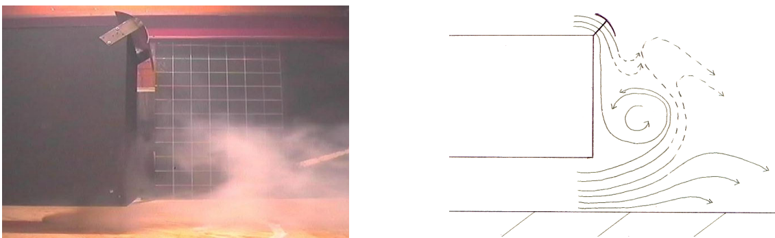
Figure 8 Résultats des tests avec becquet en haut à l'arrière. Photographie et aérodynamique supposée. Les lignes pointillées représentent les écoulements d'air faibles. (Mælum 2000)
