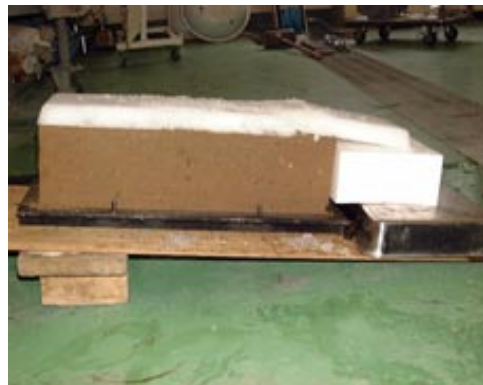
Figure 10 Test B (extrémité de la couche de neige en-dehors du spécimen de test)
