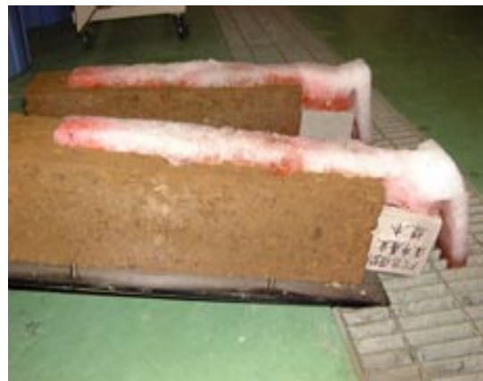
Figure 15 Test B avec angles de pente différents (premier plan: 10°, arrière-plan: 5°)
