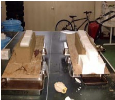
Figure 9 Test de fonte de neige en utilisant un spécimen de sol (gauche: test A, droite: test B)
