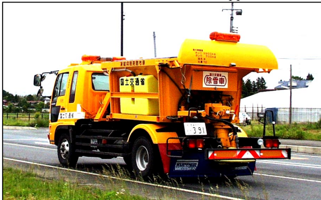
Photo 1 Répandeur de retardateur de congélation équipé par le contrôleur automatique
