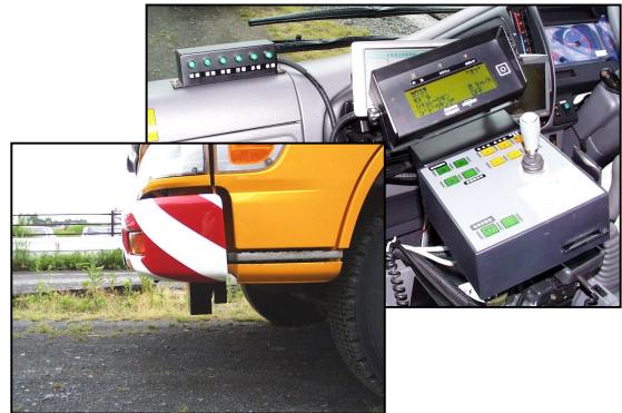
Photo 2 Panneau de commande (en haut) et capteur de discrimination de la chaussée (en bas)
